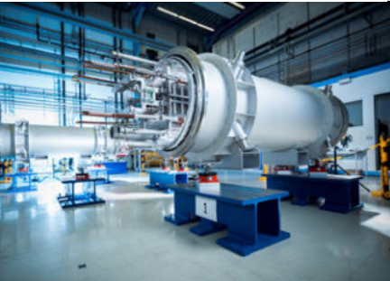
Magnete für den zukünftigen FAIR-Ringbeschleuniger SIS100 Bild: J. Hosan, GSI/FAIR
